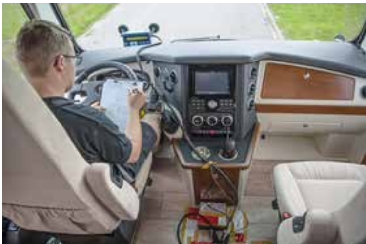
In ausführlichen Versuchsfahrten testet VB die Vor- und Nachteile der verschiedenen Fahrwerksversionen. Mit an Bord: aufwendige Messtechnik.
