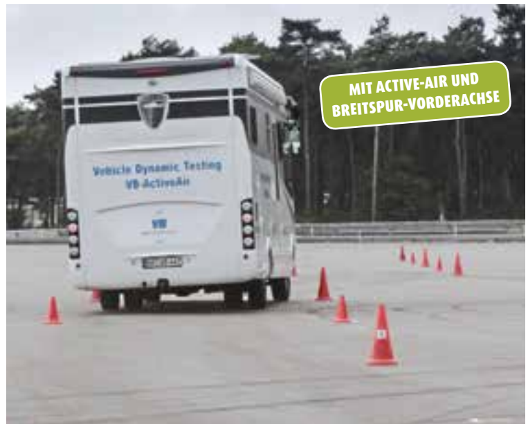
Die Adaptivdämpfer und die breite Vorderachse sorgen für eine sichtlich geringere Seitenneigung beim Durchfahren des simulierten Ausweichtests.
