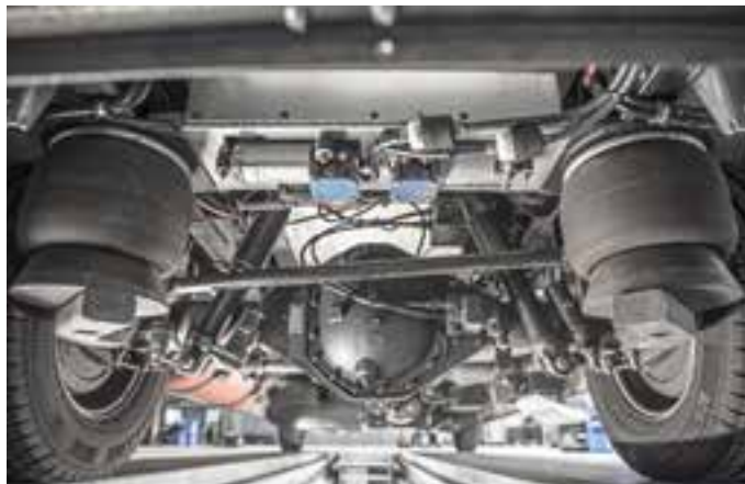
Die Gummibälge des Full-Air-Fahrwerks dienen im Stand auch zum Nivellieren. Dahinter erkennt man die adaptiven Stoßdämpfer.
