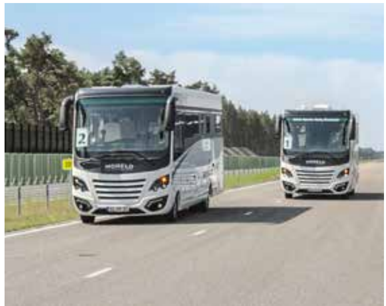
Morelo-Liner mit VB-Fahrwerken: vorne ein Palace mit Full-Air-, hinten mit Active-Air-Fahrwerk. Gut zu erkennen: die Breitspur-Vorderachse.
