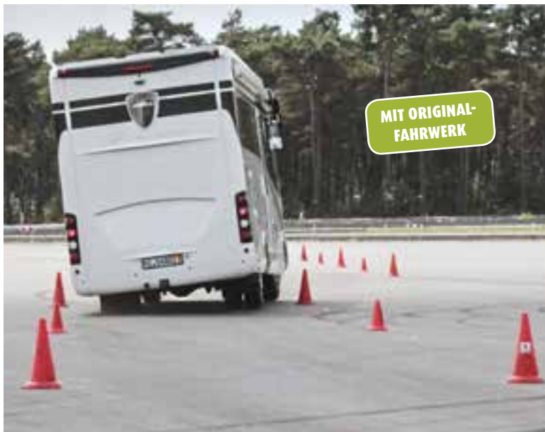
Mit Original-Fahrwerk neigt sich der Morelo Palace auf Iveco Daily deutlich aus der Kurve – hier beim doppelten Spurwechsel auf der Teststrecke.
