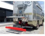
Kürzlich wurde der Prototyp unseres innovativen Motorrad- und Reserveradträgers fertiggestellt und getestet. Mithilfe der Seilwinde lässt sich das massive Gestell bis in Bodennähe absenken, um Ersatzräder und Motorrad bequem aufzuladen. Highlight des Konzepts ist der ausfahrbare Unterfahrschutz, der mithilfe einer Scherenkonstruktion nach hinten ausfährt und so den gesetzlichen Maximalabstand zum Fahrzeugheck einhält.
