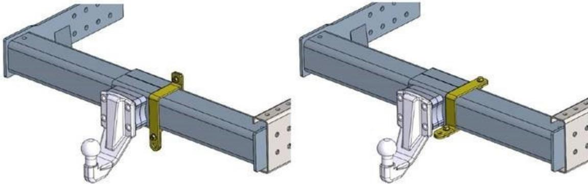
Halteöse für Abreißseil: jetzt erhältliche Nachrüstmöglichkeit für Anhängerkupplungen (AHK) der Fa. Fahrzeugbau Meier! In vielen europäischen Ländern wird die Befestigung des Sicherungsseils des Anhängers an einer separaten Öse gefordert. AHKs nach der neuen Norm ECE R55 verfügen über eine entsprechende Öse. Für Fahrzeuge mit AHKs nach der alten Norm EWG94/20 gab es bisher keine Nachrüstmöglichkeit (siehe Newsletter 04-2019).
